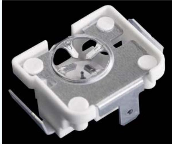
Il generatore nanoe™ raccoglie l'umidità invisibile nell'aria e applica l'alta tensione per produrre particelle d'acqua di dimensioni nanometriche, chiamate "**particelle di acqua atomizzata elettrostatica**" in quanto dotate di carica elettrica.
